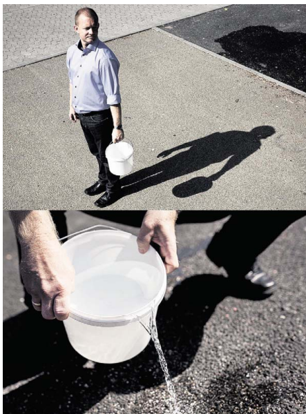
SKYBRUD. Med en spand genskaber projektchef Michael Brask, NCC, sidste søndags skybrud. Og den vandgennemtrængelige asfalt suger vandet til sig og sender det ned i undergrunden. Foto: Daniel Hjorth
